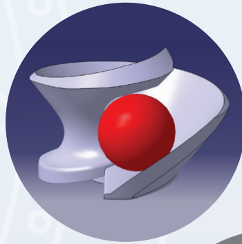
3D-модель рабочего колеса с проверкой проходимости
