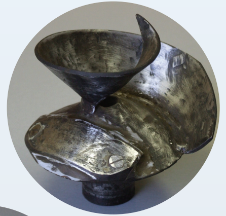
Несбалансированное рабочее колесо (сварная конструкция)
