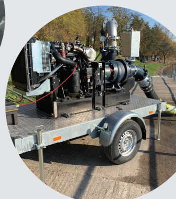
Finálny test čerpadla SPIRAM 200
