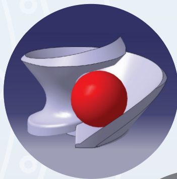
3D model obežného kola s kontrolou priechodnosti
